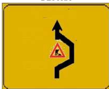
PREAVVISO DI DEVIAZIONE
