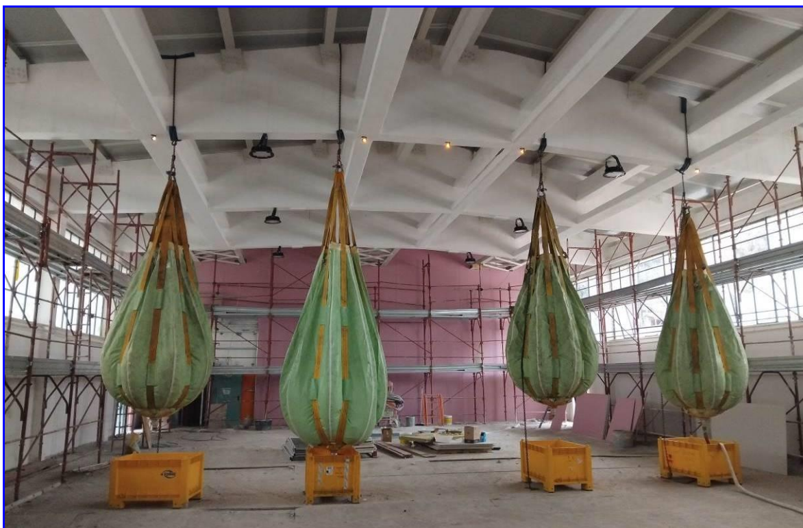
Sacconi di carico (al 50%) e prismi topografici
