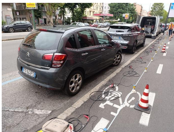
Stendimento dei n. 24 geofoni di misura e fase di energizzazione
