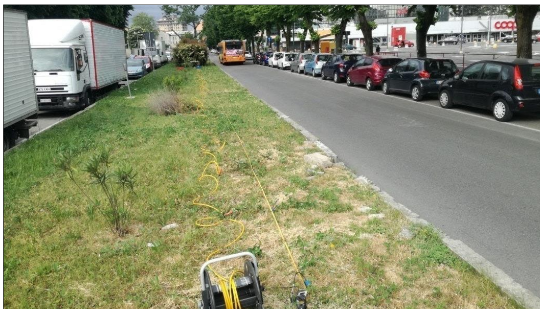
Figura 2: dettaglio stendimento sismico prova MASW 2 ("SestoSG_A2")
